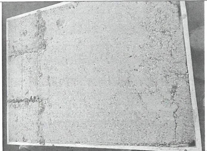
**Foto 2.** IZOLAȚIE CELULOZICĂ tip FIBRATUS pusă în operă sub presiune, în tipar din lemn
